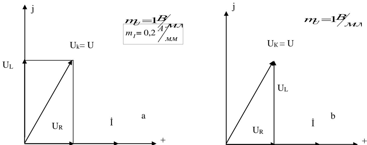
Рисунок 5 – Векторная диаграмма (а) и топографическая диаграмма катушки индуктивности (б)
