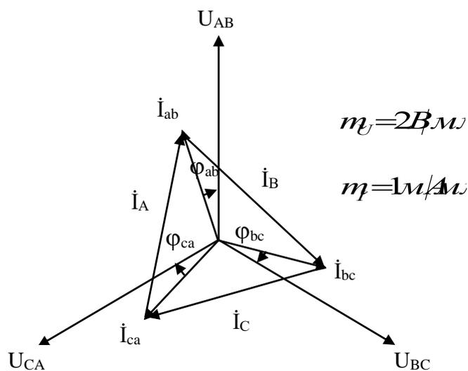
Рисунок 20 – Векторная диаграмма токов и напряжений симметричной нагрузки
