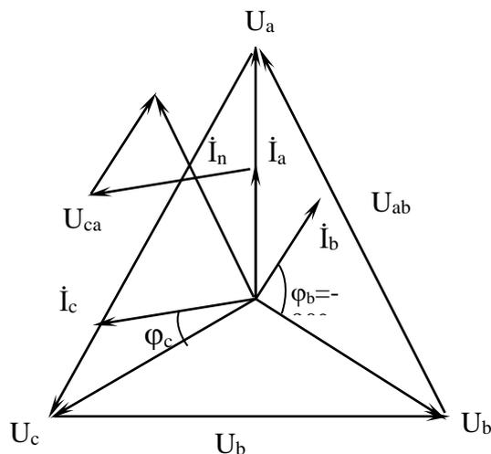
Рисунок 16 – Векторная диаграмма токов и напряжений при несимметричной активно-индуктивно-ёмкостной нагрузке с нейтральным проводом.
