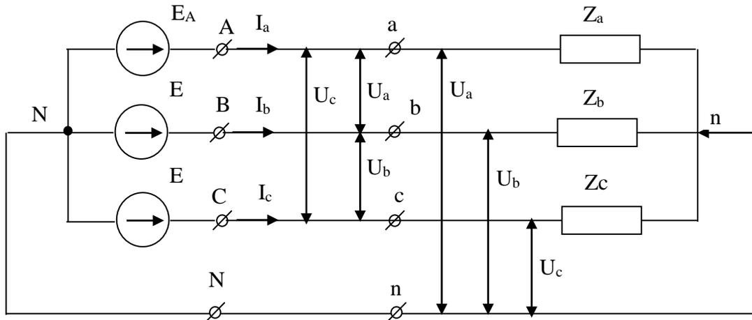
Рисунок 14 – Трёхфазная цепь при соединении нагрузки звездой
