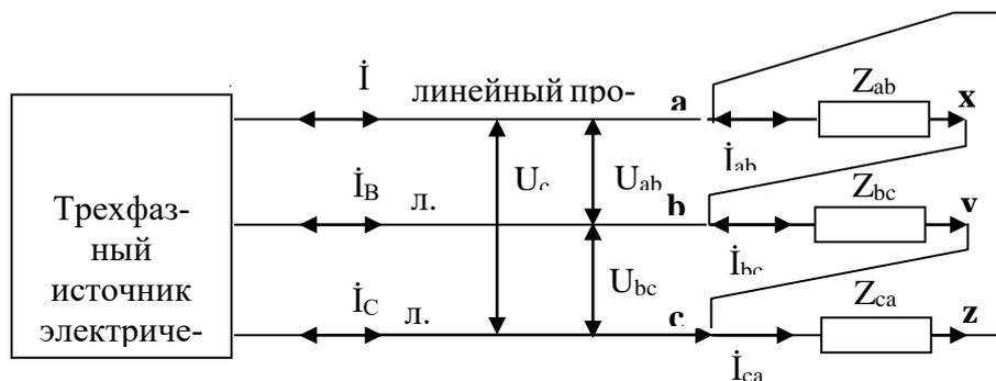
Рисунок 19 – Трёхфазная цепь при соединении нагрузки треугольником
