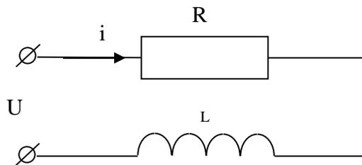
Рисунок 4 – Схема замещения катушки индуктивности
