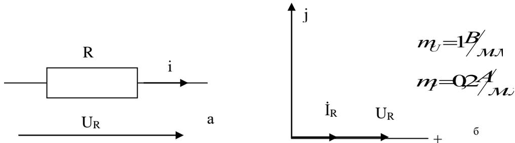
Рисунок 2 – Графическое изображение резистивного элемента (а) и векторной диаграммы тока и напряжения для резистивного элемента схемы замещения (б)
