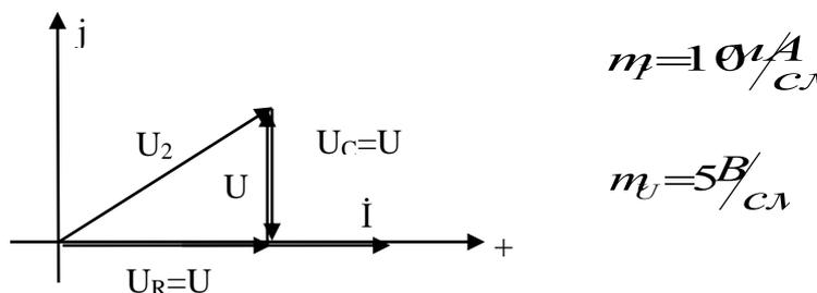
Рисунок 9 – Векторно-топографическая диаграмма тока и напряжений при резонансе напряжений в цепи
